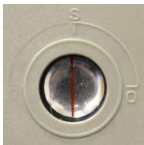
Рисунок 3 – Индикатор указывает, что клапан закрыт.
