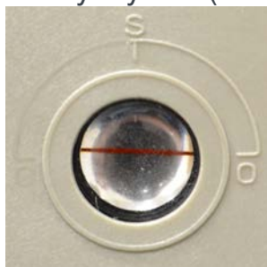
Рисунок 2 – Индикатор указывает, что клапан открыт.
