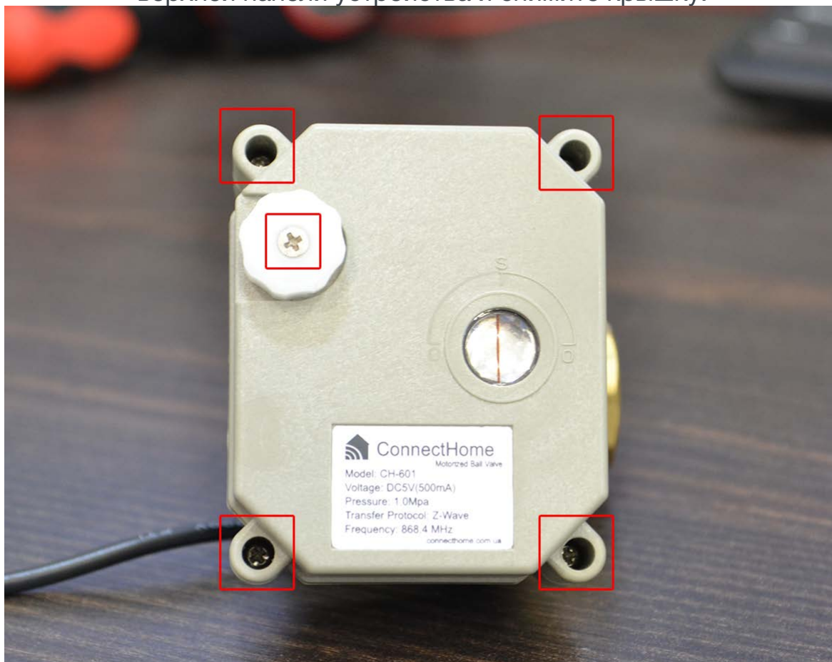
Рисунок 4 – Расположение болтов для снятия верхней крышки.
